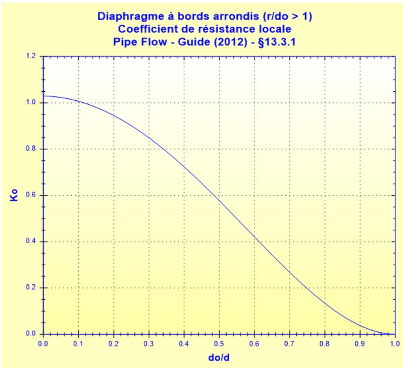
Coefficient de perte de pression totale (basé sur la vitesse moyenne dans le tuyau) :
