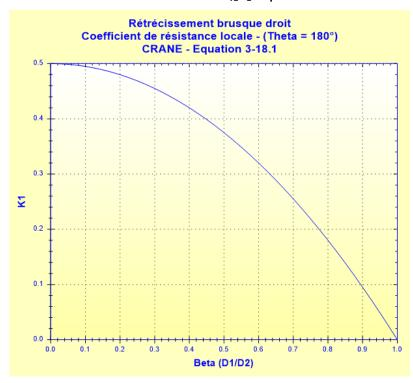
Coefficient de perte de pression totale (basé sur la vitesse moyenne dans le petit diamètre) :
